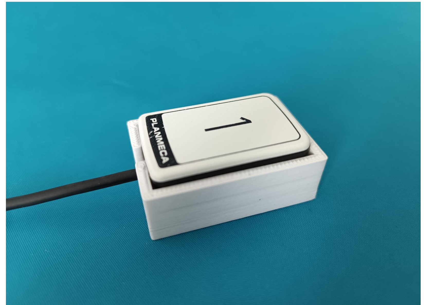
Umožňuje umístit detektor do vodorovné pozice pro testování fantomu
