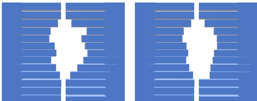
Obr. 1: Lamely, obrázek má ukazovat jejich různé možnosti nastavení. Nacházejí se v klinickém urychlovači částic.
